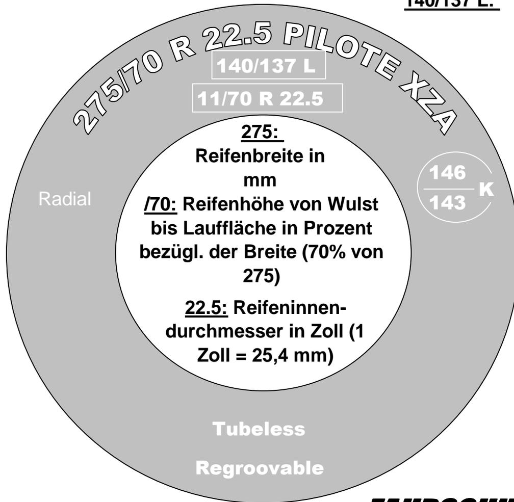
140/137 L: 140 = Tragfähigkeitskennzahl bei Einzelbereifung
